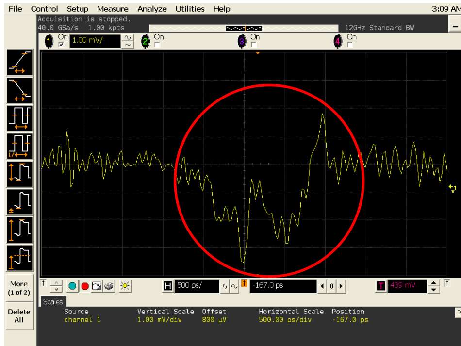
Abb. 6.5: Aufnahme des Leckens des IQ-Mixer, nachdem ein DC-Puls auf die beiden Ports I und Q gegeben wurde. Die Mikrowelle blieb ausgeschaltet.
